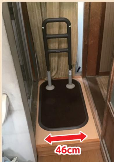
浴室から居間へ移動する廊下に支えがない。段差をまたがずに設置ができる、幅が狭いベースのクリンディを選定。
